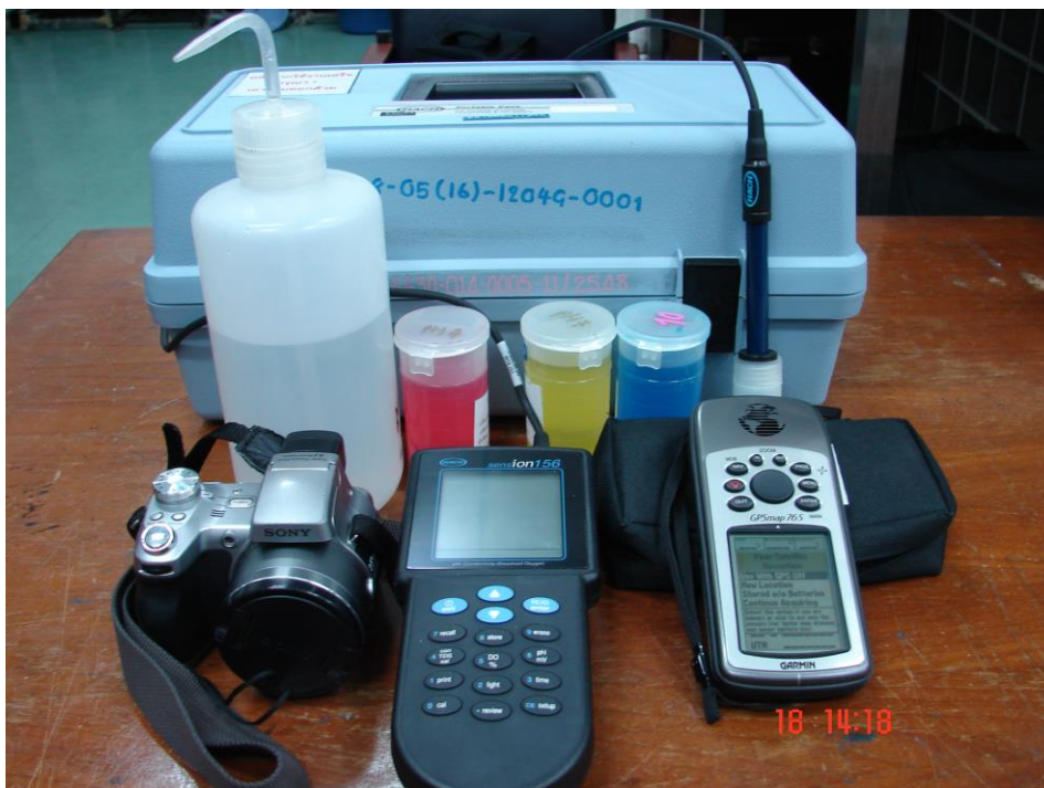
รูปที่ 5 เครื่องมือที่ใช้ในภาคสนาม ได้แก่ เครื่องวัดพีเอช กล้องถ่ายรูปดิจิทัล และเครื่องวัดพิกัดดาวเทียม
