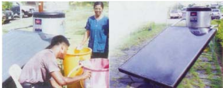
เครื่องสกัดสารป้องกันและกำจัดศัตรูพืช โดยใช้พลังงานแสงอาทิตย์
