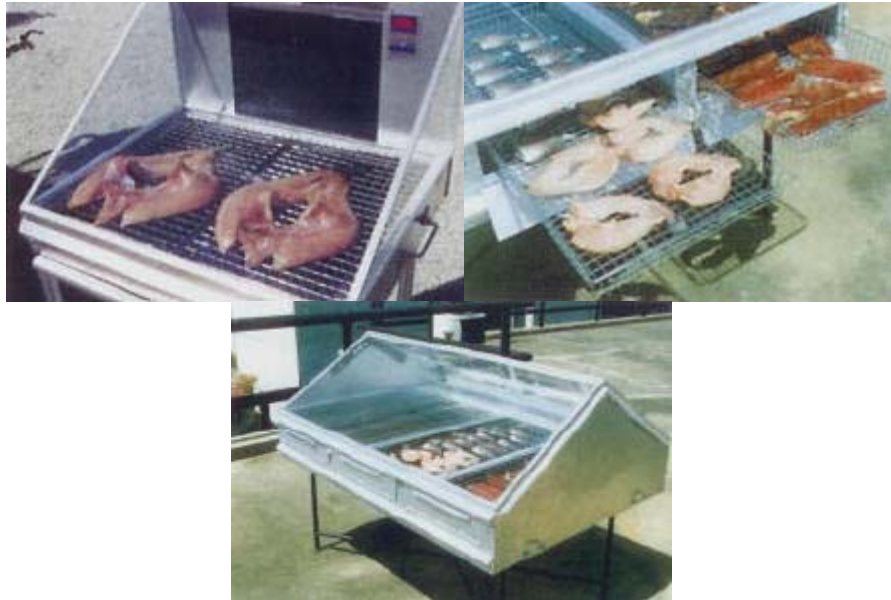
เครื่องอบแห้ง เช่น กุ้ง ปลา โดยใช้พลังงานแสงอาทิตย์
