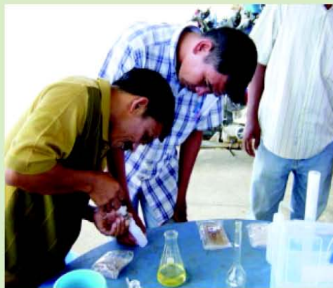
นำตัวอย่างน้ำที่เก็บมาทำการตรวจวัดเพื่อหาค่าออกซิเจนละลายน้ำ
