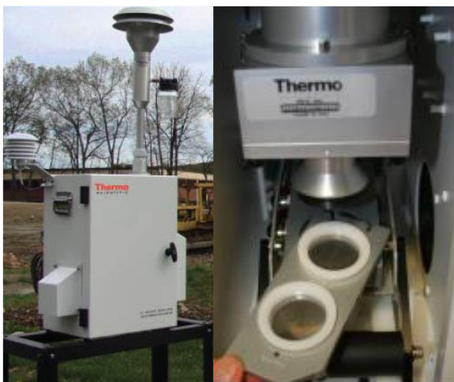
เครื่องเก็บตัวอย่างฝุ่นละอองระบบไดโคโทมัส
