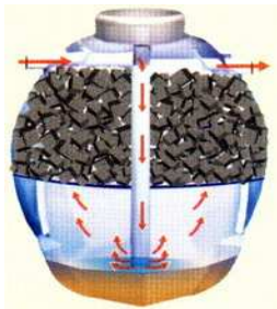
ภาพที่ ๗ ถังกรองไร้อากาศ
